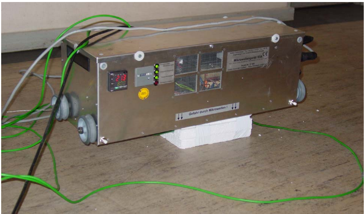
Abbildung 3: Mikrowellenbehandlung des eingehausten Prüfkörpers mit biologischen Proben
