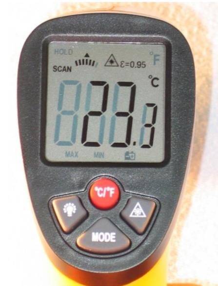
Bitte beachten Sie: Das Gerät ist sehr empfindlich gegen Mikrowellen! Messen Sie bei Mikrowellenbetrieb nur aus dem sicheren Expositionsbereich 2 heraus und legen es auch dort ab. Schon der Betrieb des Gerätes im Expositionsbereich 1 kann zum Defekt des Gerätes führen. Genaue Messungen sind nur bei abgeschaltetem  $\mu$ W-Betrieb möglich.
