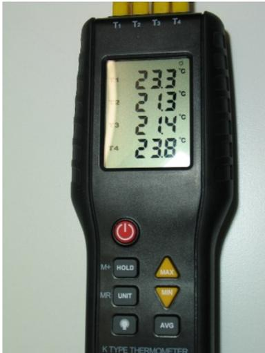
4 Messeingänge mit großem, beleuchteten LCD-Display, mit Min-, Max- und Mittelwertspeicher, Genauigkeit 1 °C, Auflösung 0,1 °C. Automatische Abschaltung nach 10 min. ohne Bedienung.
