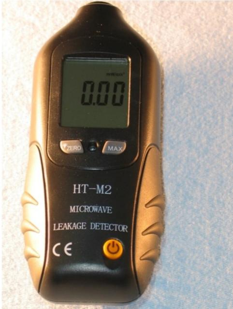
Wenn das Mikrowellen-Restpotential-Messgerät LCM2 eingeschaltet ist, begeben Sie sich auf den messtechnischen Rundgang. Halten Sie das Gerät mit der vorderen runden Front in Richtung des Mikrowellen-Generators. Beginnen Sie aus dem sicheren Expositionsbereich 2 in Richtung des Mikrowellen-Generators. Bewegen Sie es nach oben und unten abwechselnd, damit Sie auch eventuelle Hot-Spots sicher erfassen. Wenn die Anzeige 5 mW/cm<sup>2</sup> erreicht, befinden Sie sich an der Grenze
